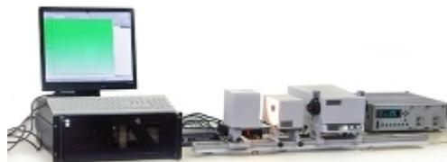
Установка обеспечивает проведение независимой проверки, регулировки и контроля установки и измерения длины волны по линии излучения гелий-неонового лазера с рабочей длиной волны 632,8 нм. Установка состоит из малогабаритного монохроматора МДР-204 со специально изготовленными согласующими устройствами и ваттметра волоконно-оптического ОМЗ-109 с двумя сменными блоками – опорными приёмниками. Установка работает под управлением ПЭВМ.
